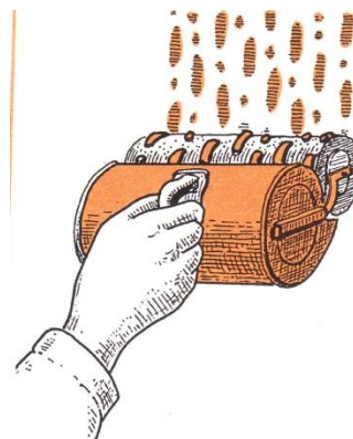
Obr. 19 Válečkování pomocí válečkovacího přístroje – vaničky
